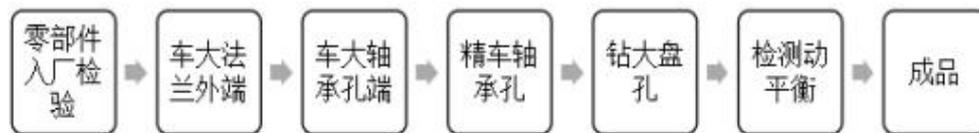
图 3-3 前轮毂加工工艺流程图
