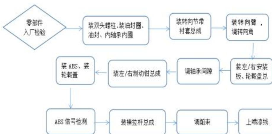
图 3-6 鼓式前桥装配工艺流程图
