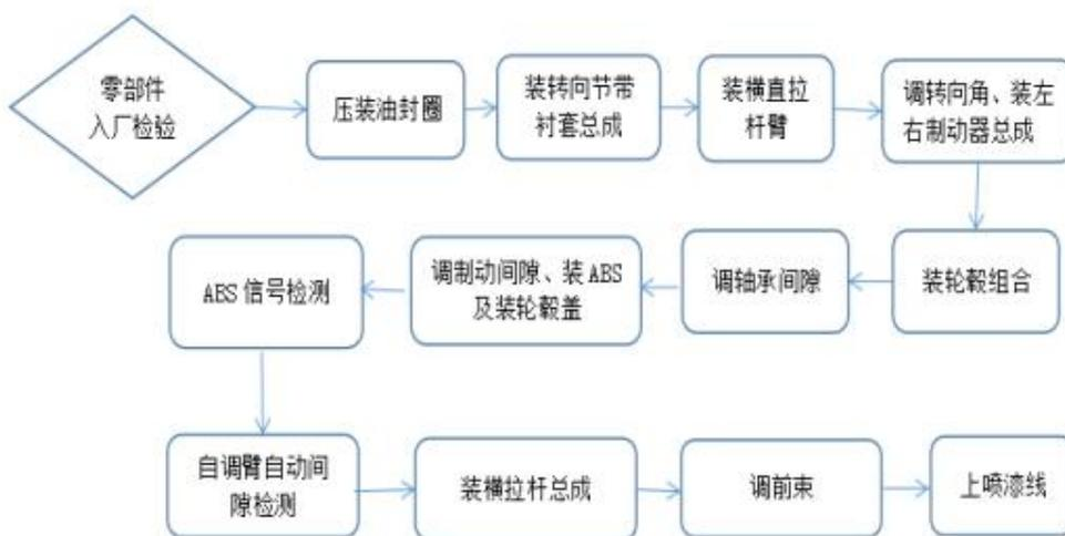
图 3-5 鼓式前桥装配工艺流程图
